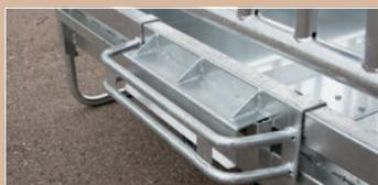
Dreipunkthängung (mit Schutzbügel)
