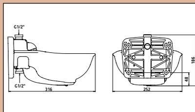
Die Abdeckung an der Unterseite des Beckens und die geschlossene Bauweise im Bereich des Ventilzulaufs wirken isolierend und verhindern ein Entweichen der vom Heizkabel abgegebenen Wärme.
