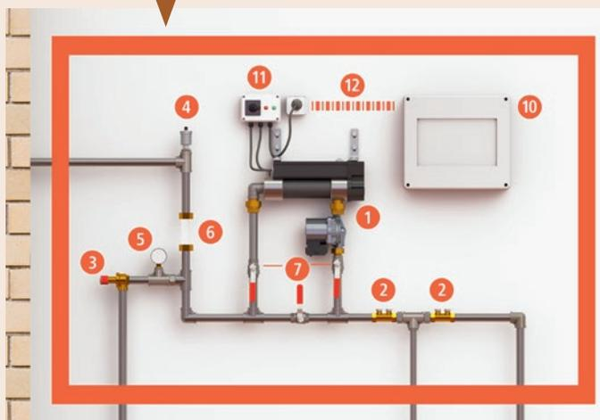
Montage mit BYPASS-System – Durch die Kugelhähne kann die Pumpe einfach und schnell von der Ringleitung getrennt werden. Durch die beiden mitgelieferten selbstdichtenden Verschraubungen kann die Pumpe nach dem Abtrennen schnell und unkompliziert ausgebaut werden.
