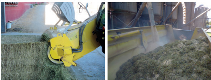
Abbildung 1: Das Fasermaterial wird so lange gemischt, bis eine optimale Häcksellänge von 2 bis 2,5 cm erreicht wird.
